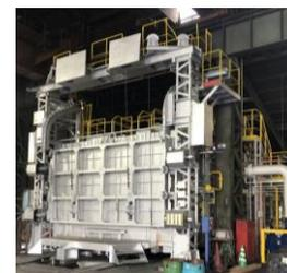
M1台車式 焼鈍炉
